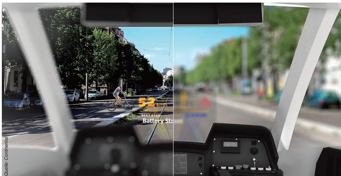
Abbildung 3: Wirkung eines Combiner Head-up-Displays: Die Schärfenebenen von Anzeige und Verkehrsgeschehen liegen dicht beieinander (linke Bildhälfte), anders beim konventionellen Instrument (rechte Bildhälfte)
